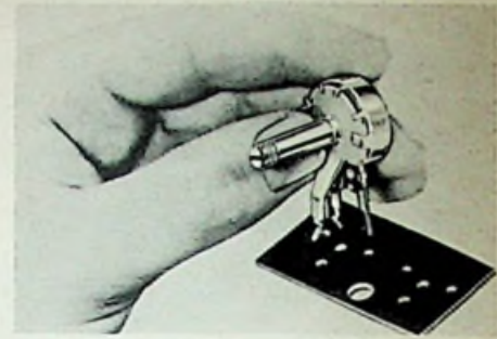
Bild 1 Kleinpotentiometer mit snap-in-Befestigung für gedruckte Schaltungen
