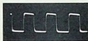
Bild 9. Eine mit dem Transistor-Multivibrator erzeugte Rechteckschwingung
