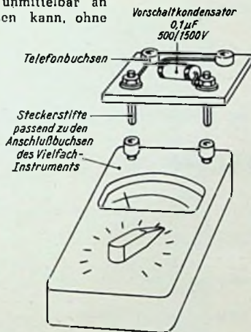
Eine praktische Ausführungsform für das Aufsteckbrettchen mit dem Vorschaltkondensator
